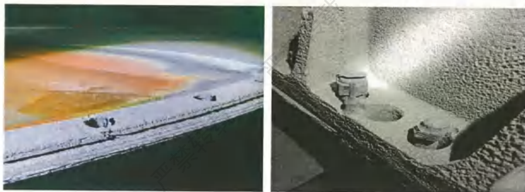
图 3 换热器、管道、阀门等设备腐蚀情况
