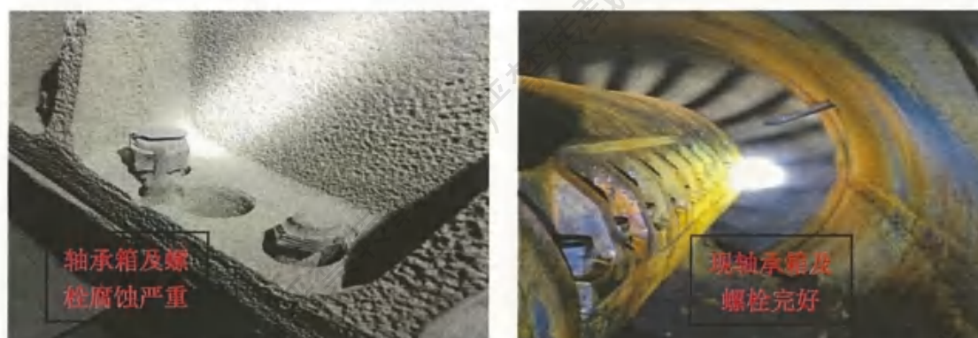
图8 3#TRT 轴承箱腐蚀前后对比
